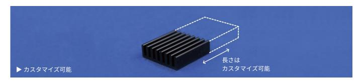
熱伝導性がいい、軽く、加工しやすい金属 (アルミ、銅の方が多い)は発熱素子の表面に貼りつけることができ、普及している電子放熱部品です。どうやってヒートシンクの熱伝導率と放熱面積を高めて、機構の放熱効率を良くさせるのは各産業の課題となります。ヒートシンクの製造方法は、プレス、押出し、ダイキャスト、鍛造があって、作られた完成品は放熱素子、機構部品、あるいは筐体として使えます。
